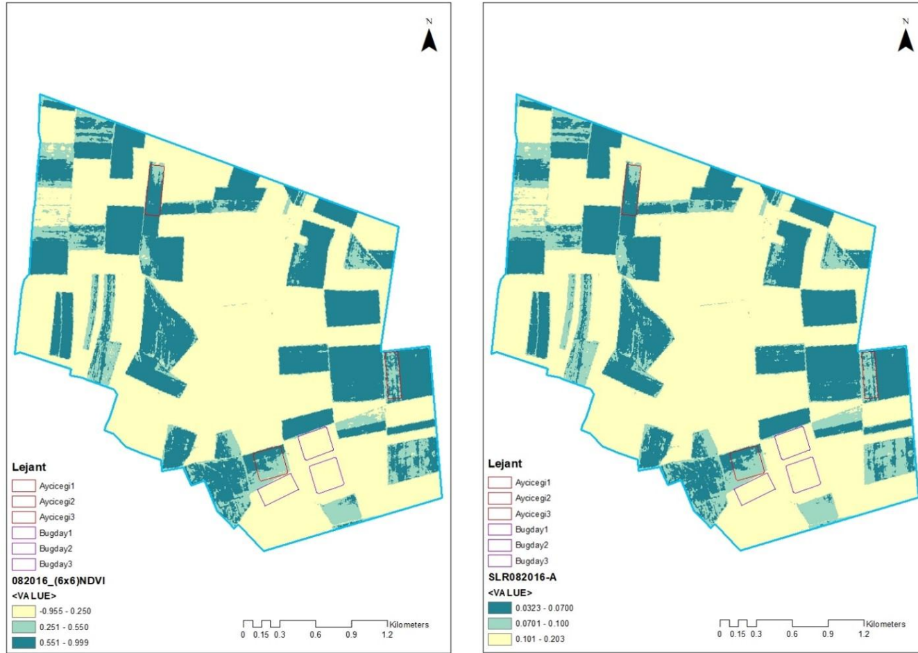
Şekil 4.39 Ağustos 2016 NDVI (6m × 6m) (sol) ve Ayçiçeği SLR (6m × 6m) (Toprak Kaybı Oranı) tabakası (sağ)
