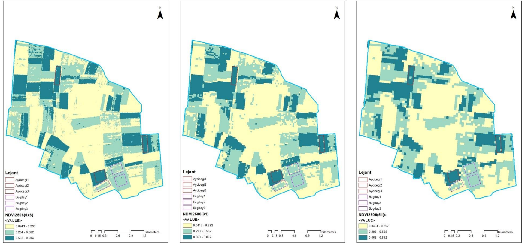
Şekil 4.35 Haziran 2016 NDVI tabakaları (sol: 6m × 6m, orta: 31m × 31m ve sağ: 51m × 51 m)
