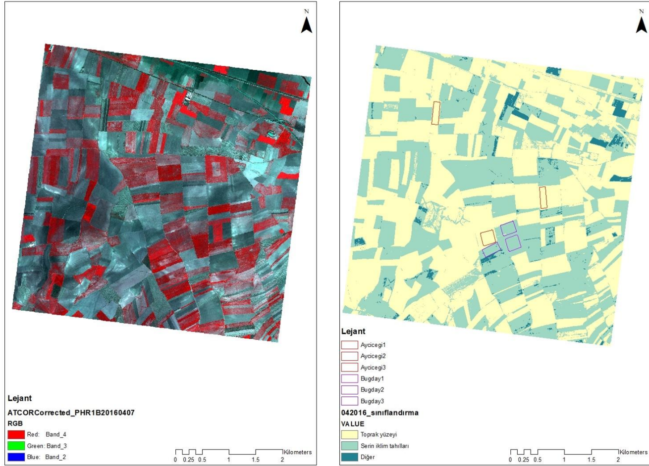
Şekil 4.32 Nisan 2016 PHR-1B multispektral görüntü (sol) ve en büyük olabilirlik sınıflandırması (maximum likelihood classification) tabakaları (sağ)
