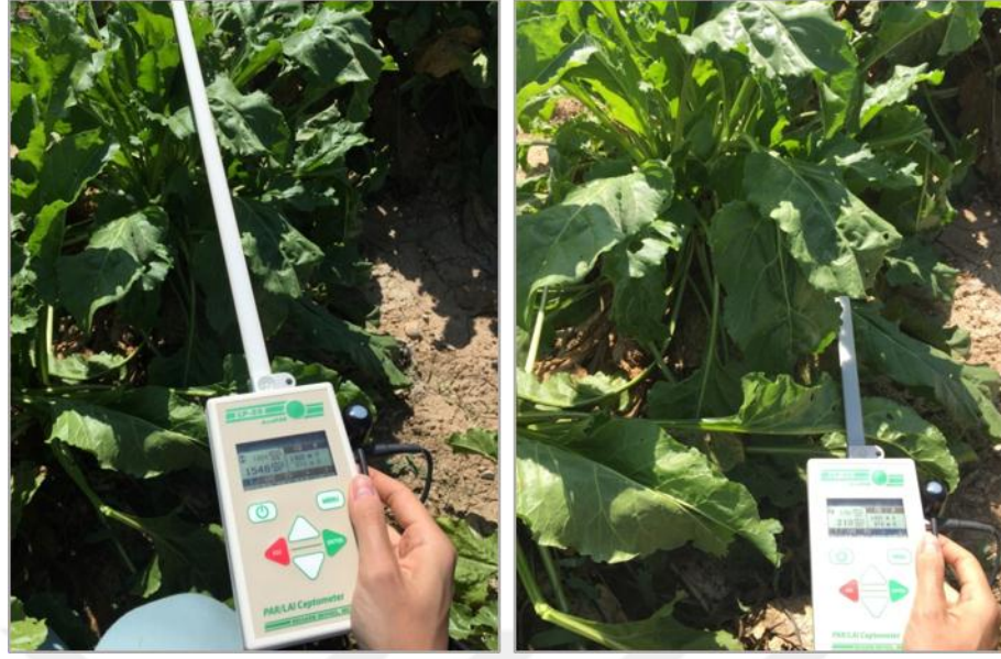
Şekil 3.16 LAI-ölçer ile yaprak alan indeksinin ölçülmesi (LP-80 ceptometer)
