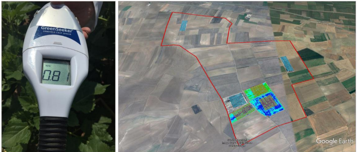
Şekil 3.17 Yersel (sol) ölçümlerde kullanılan el tipi spektrometre ve uydu görüntüleri ile (sağ) elde edilen NDVI tabakaları
