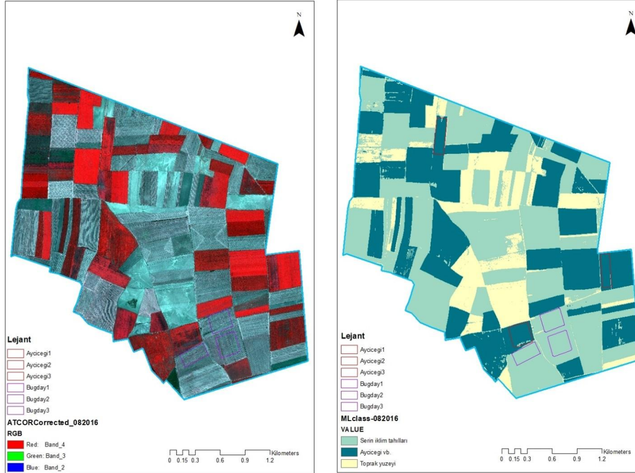
Şekil 4.38 Ağustos 2016 PHR-1B multispektral görüntü (sol) ve en büyük olabilirlik sınıflandırması (maximum likelihood classification) tabakaları (sağ)
