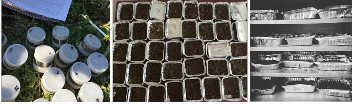
Şekil 3.12 Toprak örneklerinin alınma, tartılma ve kurutulma işlemleri
