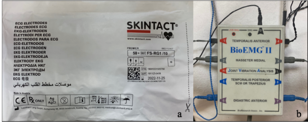
Şekil 2.12. Araştırmada kullanılan SKINTACT® FS-RG1/10 ECG yüzey elektrotları (a) ve BioPak™ BioEMG II (BioResearch Associates Inc., Milwaukee, USA) cihazı (b)
