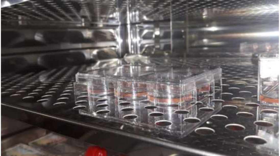
Şekil 2.2. Foto-fonksiyonelizasyon uygulanan ve foto-fonksiyonelizasyon uygulanmayan implantların hücre kültürüne alınması
