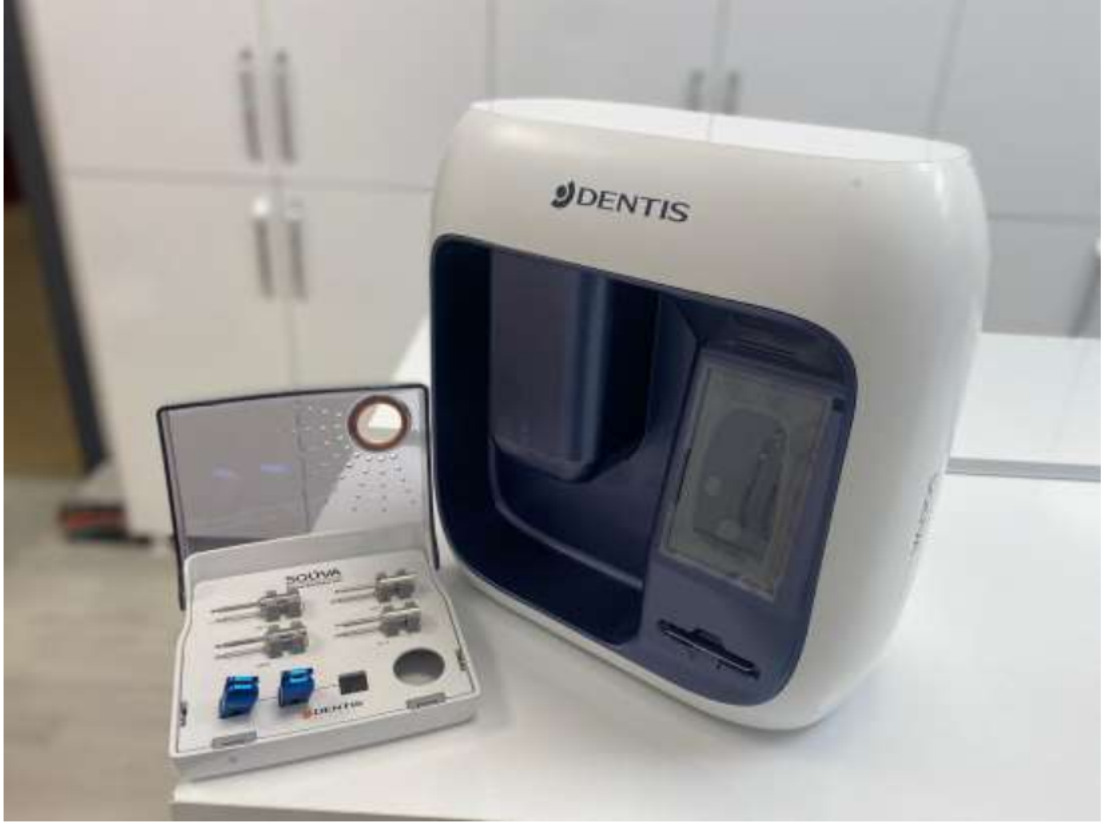
Şekil 2.1. Foto-fonksiyonelizasyon cihazı (SQ Ultraviyole Aktivatör)
