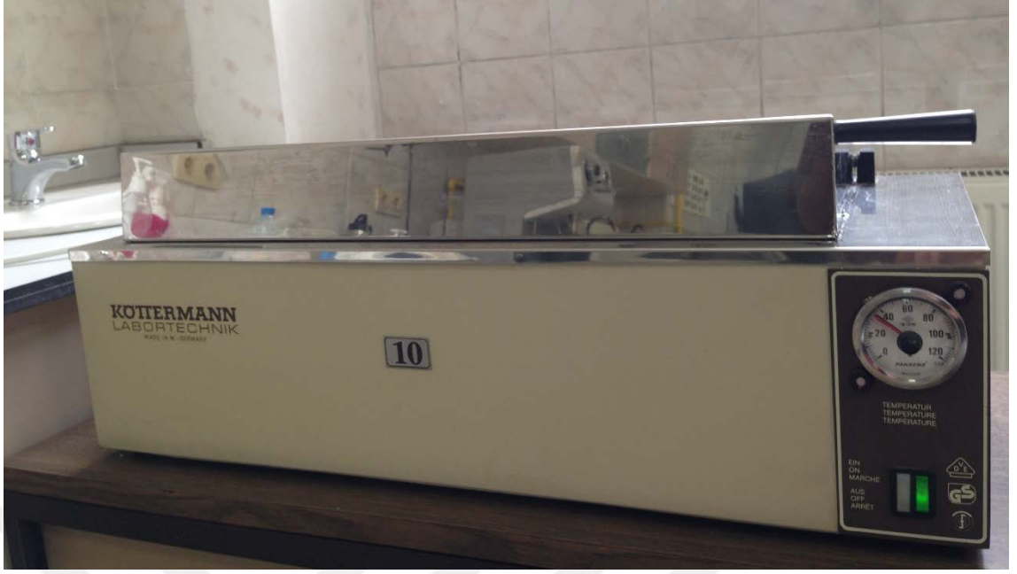
Şekil 2.5. Örneklerin yerleştirildiği etüv cihazı
