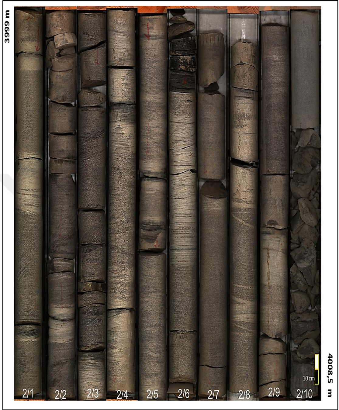
Şekil 4.11 Kuyu-4'ten alınan 2 no'lu karotun 2D fotoğrafı
