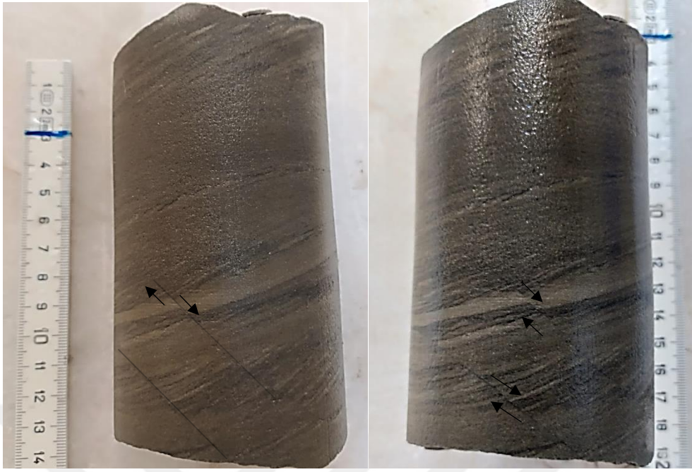
Şekil 4.9 Fasiyes 2’de gözlenen mikro faylar
