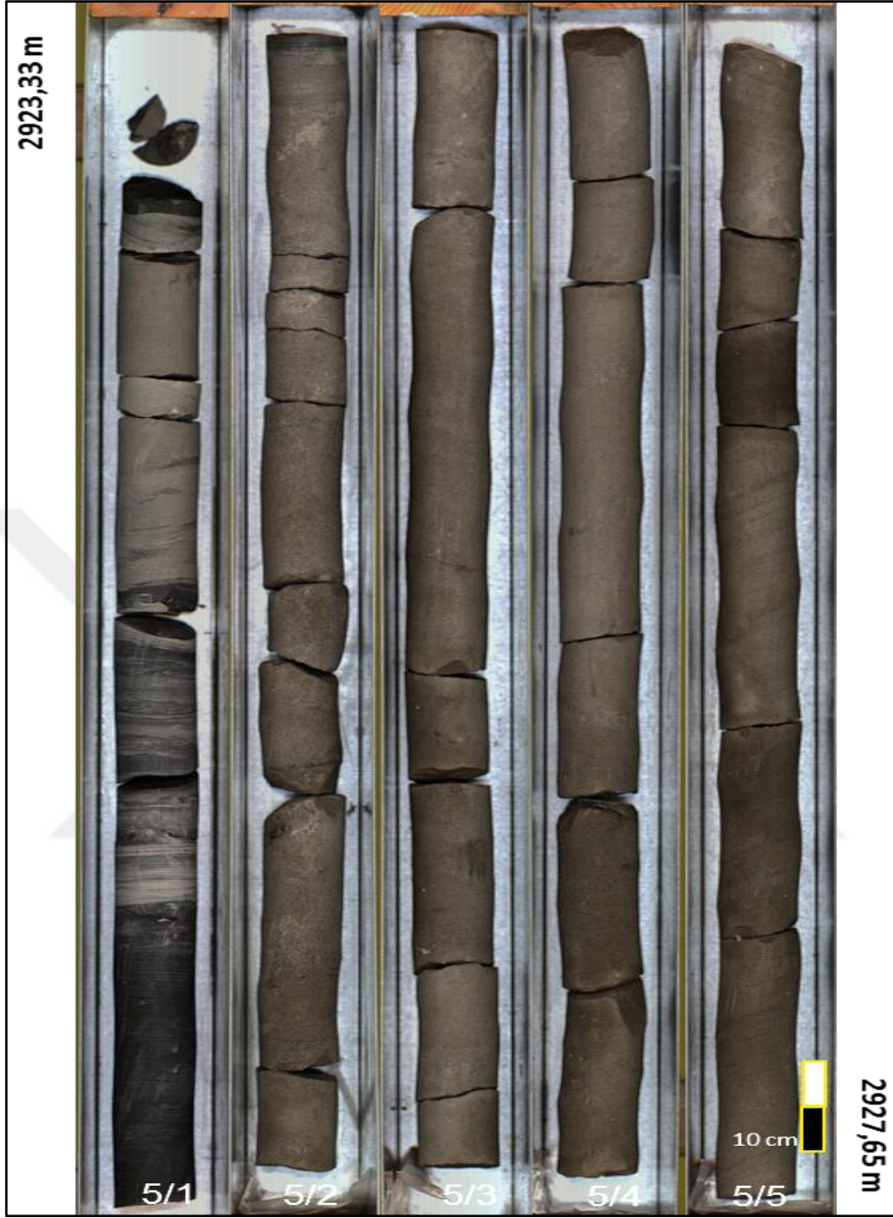
Şekil 4.4 Kuyu-3'ten alınan 5 no'lu karotun 2D fotoğraf çekimi
