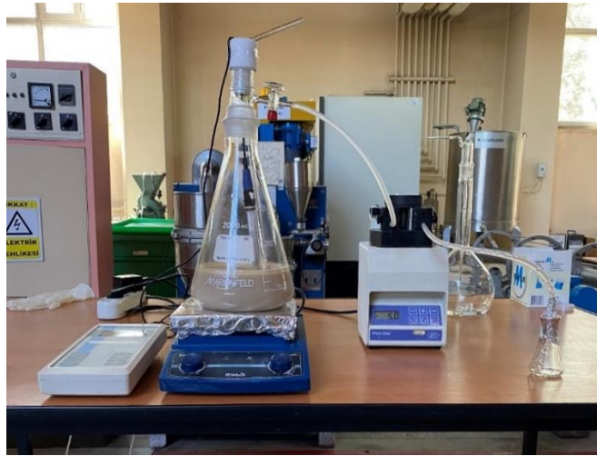
Şekil 3.10 PG/su süspansiyonuna H_3PO_4 beslemesi
