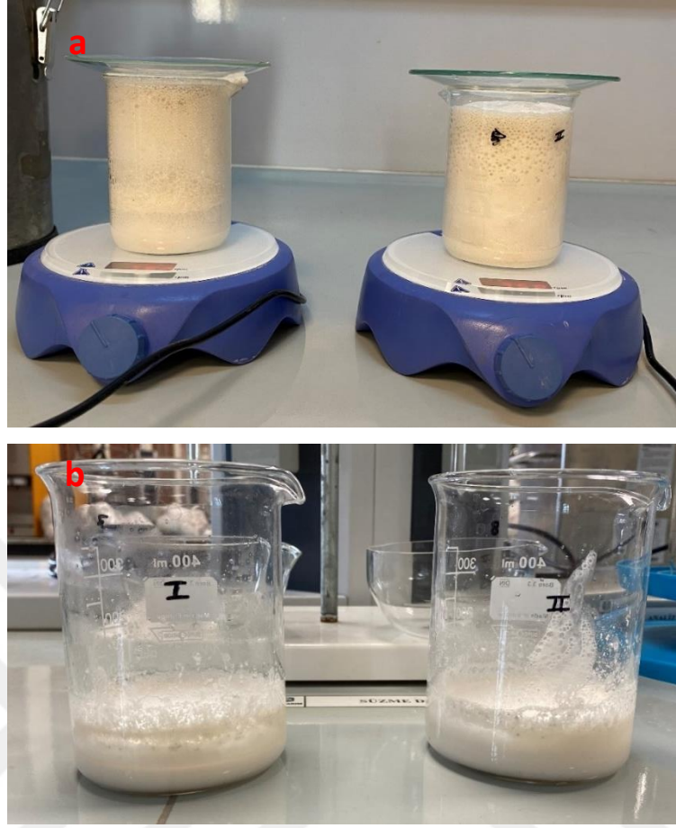
Şekil 4.15 Anhidrit jips ( \text{CaSO}_4 ) ile hazırlanan reaksiyon karışımı ((a) \text{H}_3\text{PO}_4 eklemesi sonrası, (b) Topaklaşmaların oluşumu)
