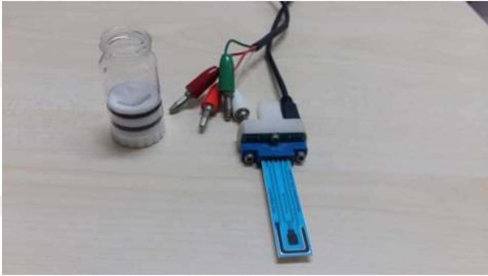
Şekil 4.1 Karbon baskı devre elektrot, bağlantılar ve elektrokimyasal hücre
