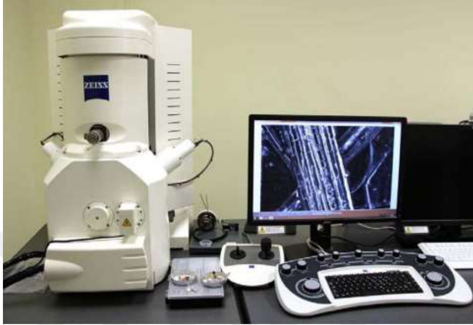
Şekil 3.9 ZEISS EVO40 marka taramalı elektron mikroskobu (SEM)
