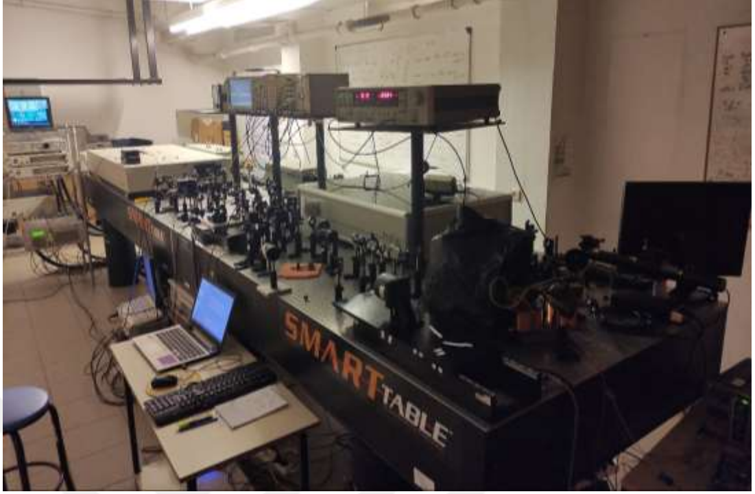
Şekil 3.10 TR-MOKE deney düzeneğinin kurulu olduğu ve deneylerin gerçekleştirildiği optik masa
