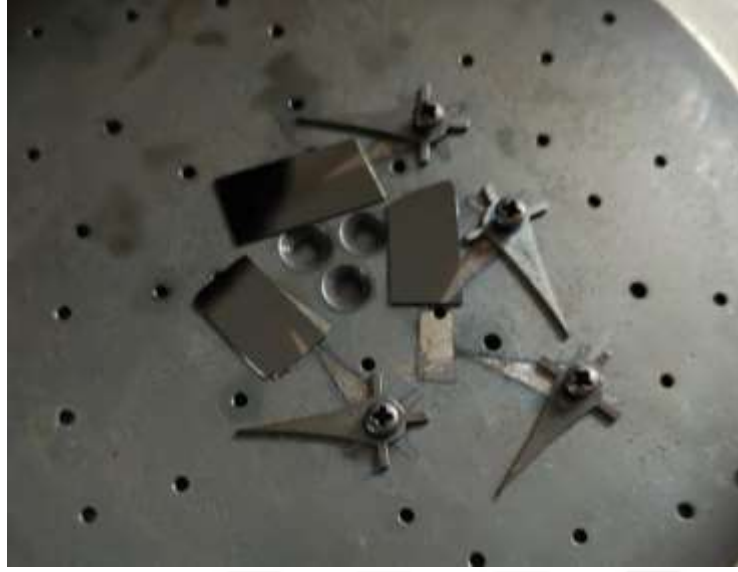
Şekil 3.3 Üretilen \text{Fe}_x\text{Co}_{(1-x)} ince film örneği
