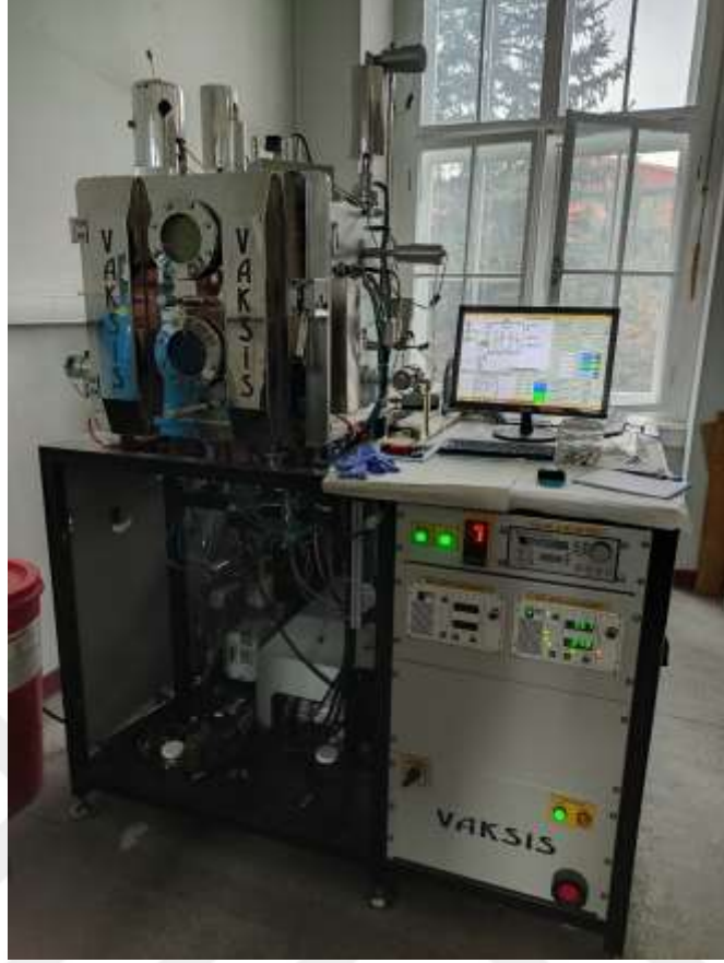
Şekil 3.1 PVD Midas 2T-4M model ince film biriktirme sistemi
