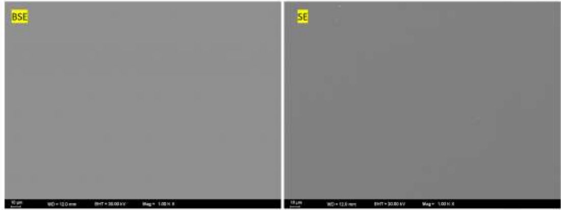
Şekil 4.3 Si/SiO 2 alttaş üzerine kaplanan co-sputter 2 (Fe 40 Co 60 ) ince filmine ait SE-BSE görüntüleri. 2 farklı bölgeden ve bir noktadan SE-BSE ve EDX analizi yapıldı. Tüm analizler birbiri ile uyumludur
