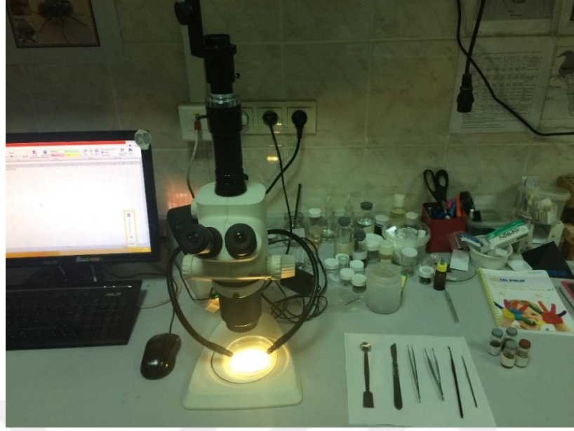
Şekil 2.3. Morfolojik teşhiste kullanılan Leica S8APO trinocular stereozoom araştırma mikroskobu ve steril laboratuvar ekipmanları
