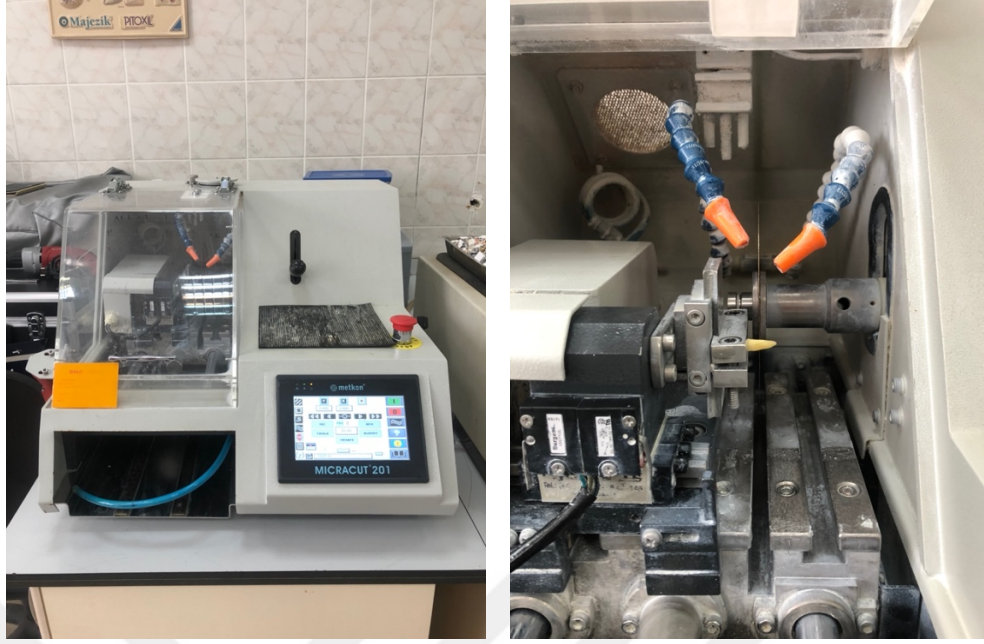
Şekil 2.1. Dişlerin Micracut ile kuron bölümlerinin uzaklaştırılması
