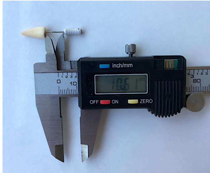
Şekil 2.2. Eğenin sap kısmı ile referans hattı arasındaki mesafenin \pm 0,01 mm hassasiyet gösteren dijital kumpas ile ölçülmesi
