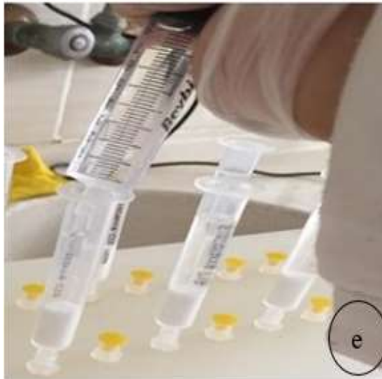
Şekil 3.4 Üzüm örneklerinde şeker ve organik asitlerin HPLC analizine hazırlanmasında ekstraksiyon çalışmaları (a: süzüntülerin 0.45 \mu çapındaki membran filtreden geçirilmesi; b: örneklerin HPLC’de okumaya hazır hale getirilmesi; c: üzüm örneğine H_2SO_4 eklenmesi; d: homojen hale getirme; e,f: C_{18} sep-pak kartuştan geçirme).
