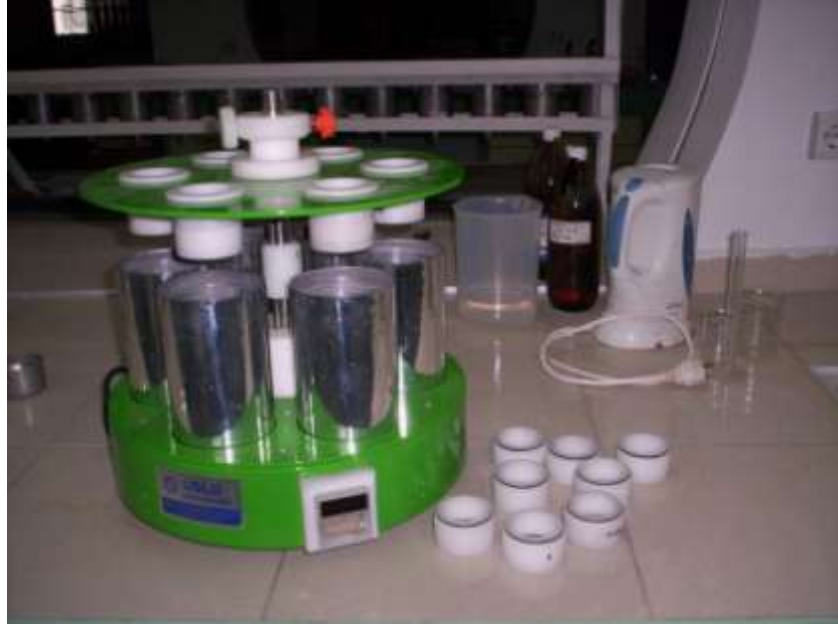
Şekil 3.5 Tek elek çapı kullanılan ıslak eleme aleti
