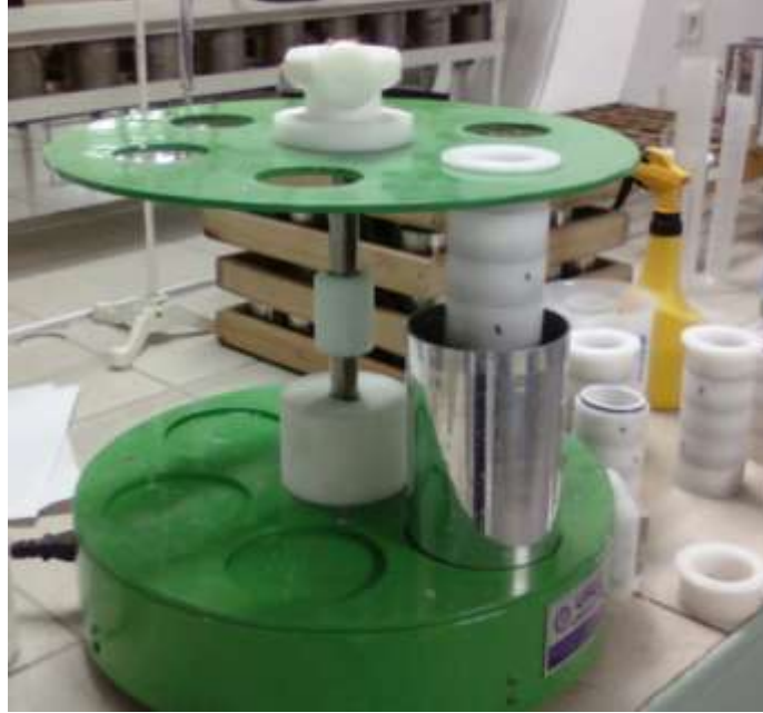
Şekil 3.6 Farklı elek ıklıkları kullanılarak ıslak eleme yapılan eleme aleti
