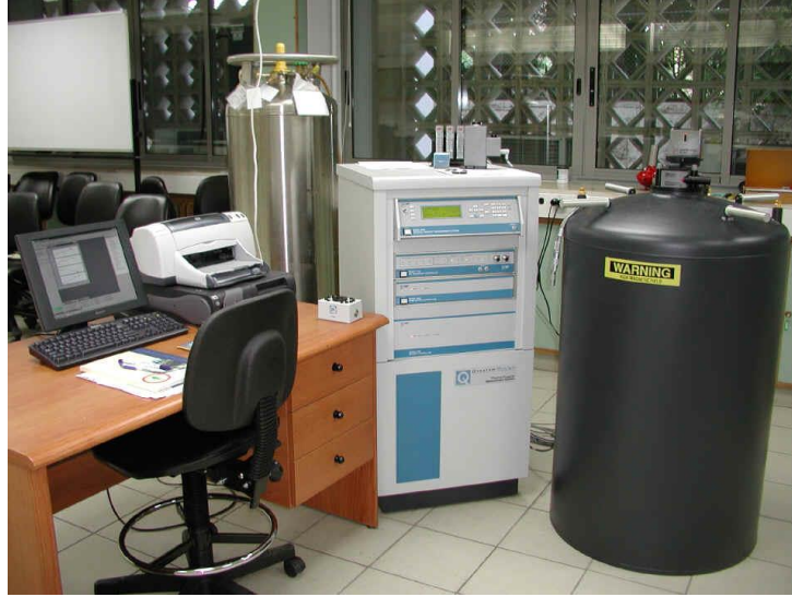
Şekil 3.10 Quantum Design PPMS cihazı
