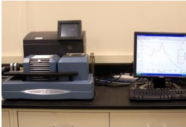
Şekil 3.9 TA Instruments SDT Q600 TGA/DSC cihazı
