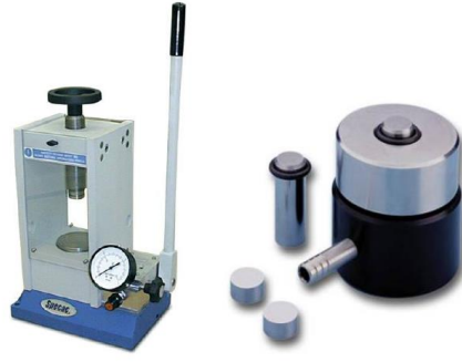
Şekil 3.2 Specac marka pres ve 1,3 cm çaplı kalıp seti
