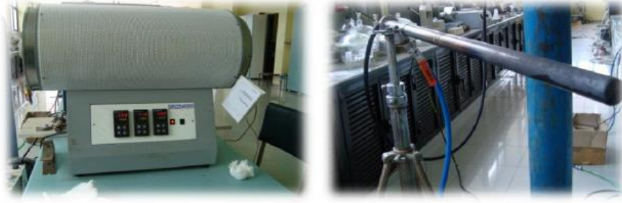
Şekil 3.5 Isıl işlemlerde kullanılan paslanmaz çelik tüp ve fırın
