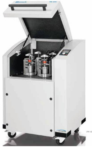
Şekil 3.1 Retsch PM400 Bilyeli Öğütücü
