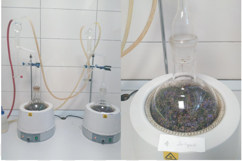
Şekil 3.15 Uçucu yağ distilasyonu (clevenger hidrodistilasyon aparatı)
