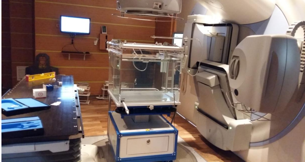
Şekil 6.2 Çalışmada kullanılan IBA Blue Phantom 2 su fantomu
