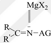
Şekil 4.2 Magnezyum tuzunun azot atomuna koordinasyonu
