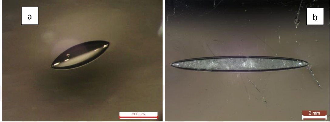
Şekil 3.4 İçi gaz dolu (a) ve katı depozitli (b) habbe hatalarına ait örnek stereo mikroskop görüntüleri
