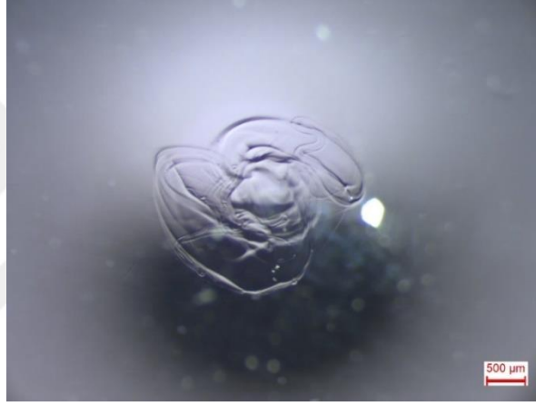
Şekil 3.2 Düğme hatasına ait örnek stereo mikroskop görüntüsü
