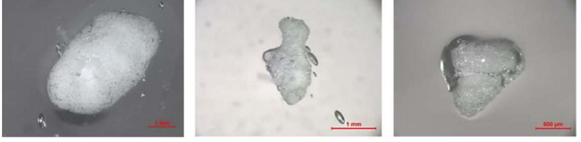
Şekil 3.5 Silika taş hatası örneklerine ait stereo mikroskop görüntüleri
