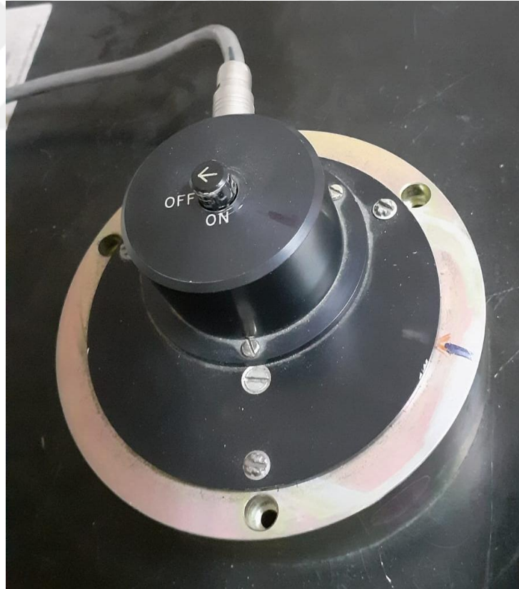
Şekil 3.20.b Elsec 9010 OSL sisteminin beta kontrol kaynağını içeren ışınlama ünitesi
