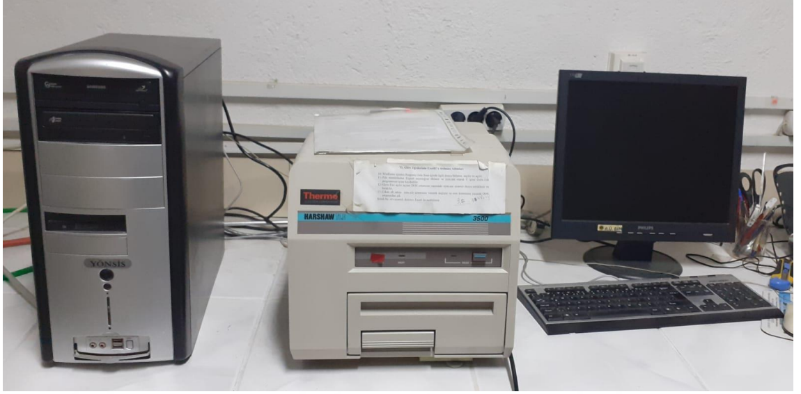
Şekil 3.23 Harshaw 3500 model TLD okuyucu sistemi
