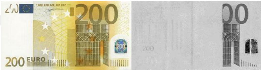
Şekil 18. 200 Euro’luk banknotta metamerik mürekkep. A) Normal ışıkta B) Kızılötesi ışıkta (Murat Durdu’nun Özel Koleksiyonu)
