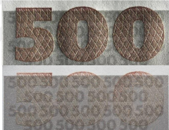
Şekil 15. 500 Letonya Lat'ında ısıl mürekkep a) normal, b) ısı uygulandığında (Murat Durdu'nun Özel Koleksiyonu)
