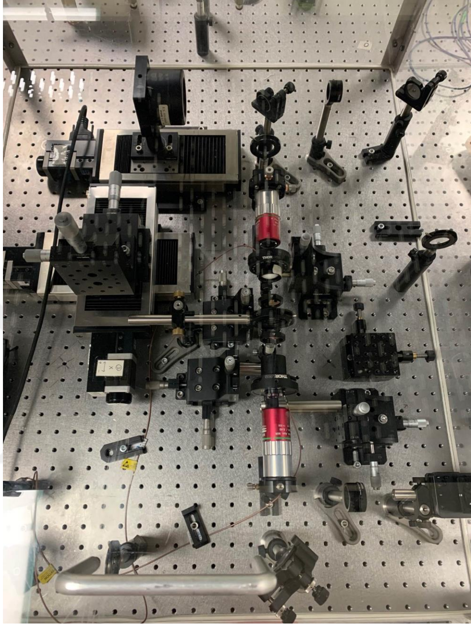
Şekil 2.7. EDFL lazer destekli THz ölçüm sistemi: Doku hareketini THz ışın odağı etrafında sağlayan özel bir kızak sistemi mevcuttur.
