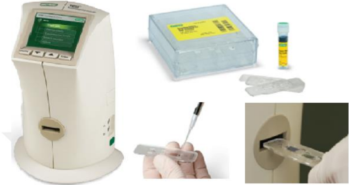
Şekil 2.2. TC 20 cihazı, kullanılan sayım lamaları ve tripan mavisi
