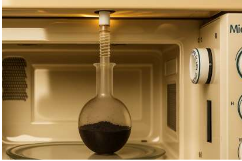
Şekil 3.2 Mikrodalga içine yerleştirilen başlangıç malzemesi/aktivasyon ajanı/metal oksit karışımı
