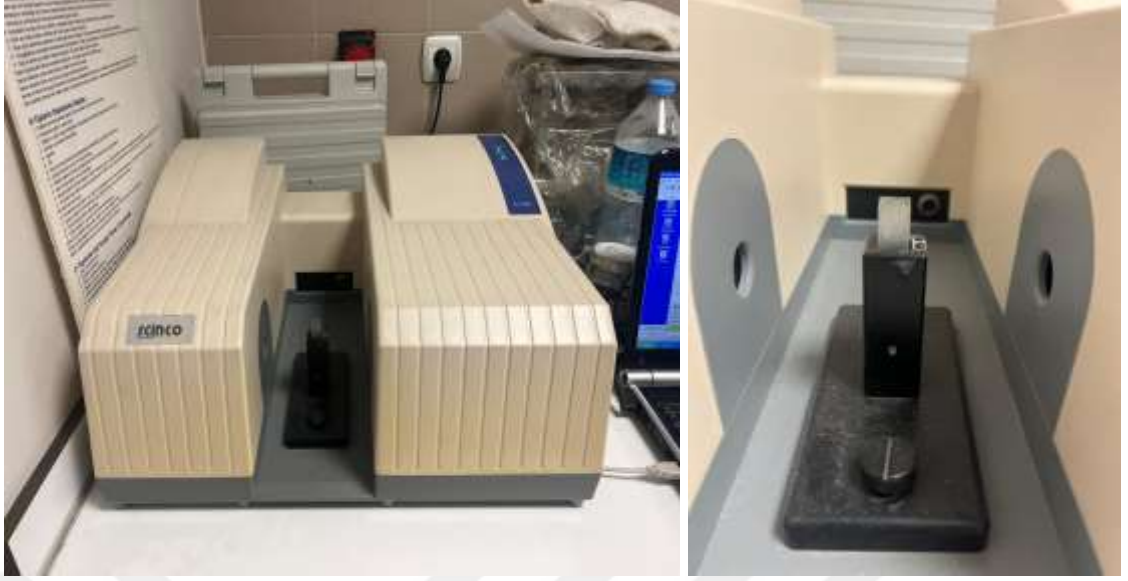
Şekil 3.8 UV analizi cihazı, kuvars küvet içine yerleştirilmiş numune
