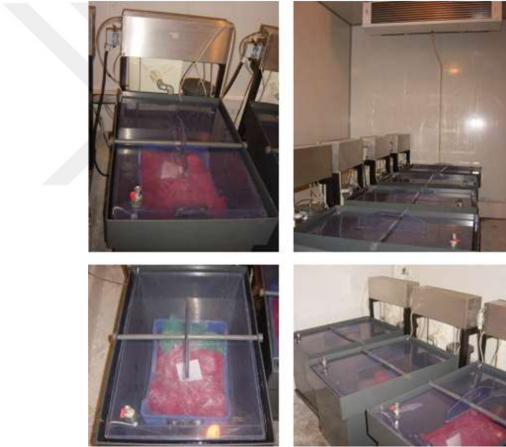
Şekil 3.11 Kontrollü atmosferli depolama çalışmasının yapıldığı kabinler
