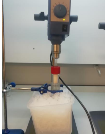
Şekil 3.4 Derişik asit ortamında ve 0-5 °C sıcaklıkta PANİ sentez düzeneđi
