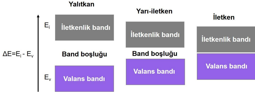
Şekil 2.10 Katılarda band teorisine göre yalıtkan, yarı-iletken ve iletken maddelerin band yapıları.
