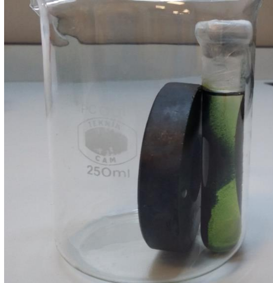
Şekil 4.29 Manyetik özellik gösteren PANİ nanokompozitini içeren sentez çözeltisinin mıknatısa tepkisi
