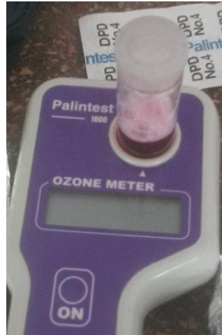
Şekil 3.1 Suda çözünen ozon miktarı ölçümünde kullanılan Palintest Ozone Meter cihazı
