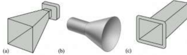
Şekil 2.2 Açıklık antenler: (a) Piramitsel horn, (b) konik horn ve (c) dikdörtgen dalga kılavuzu
