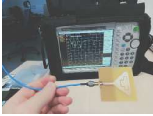
Şekil 5.20 Anten prototipinin VNA Master MS2037C ile ölçümü
