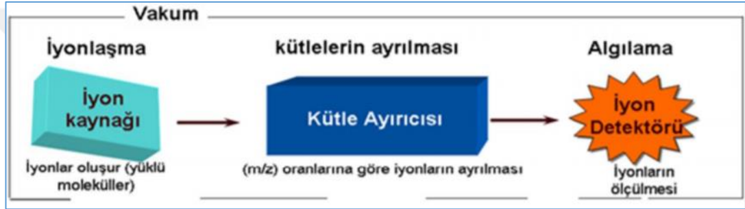
Şekil 2.6. Kütle spektrometresinin temel bileşenleri (Çal, 2014)
