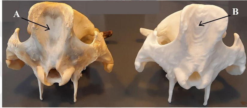
Şekil 4.1. Basım sırasında oluşan bozulmalar (A(kadavra) - B(model))
