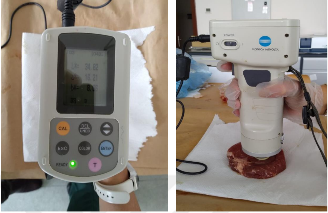
Şekil 2.6. Kırmızı ette kolorimetre (Minolta) ile renk ölçümü.
