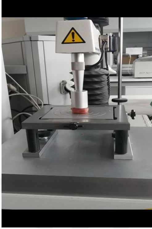
Şekil 2.8. TA.XTPlus Tekstür Analiz Cihazı ve Alüminyum Silindir Prob (A.Ü. Gıda Mühendisliği Fakültesi).
