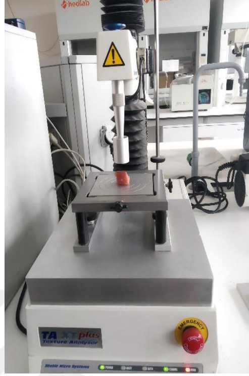
Şekil 2.8. TA.XTPlus Tekstür Analiz Cihazı ve Alüminyum Silindir Prob (A.Ü. Gıda Mühendisliği Fakültesi).
