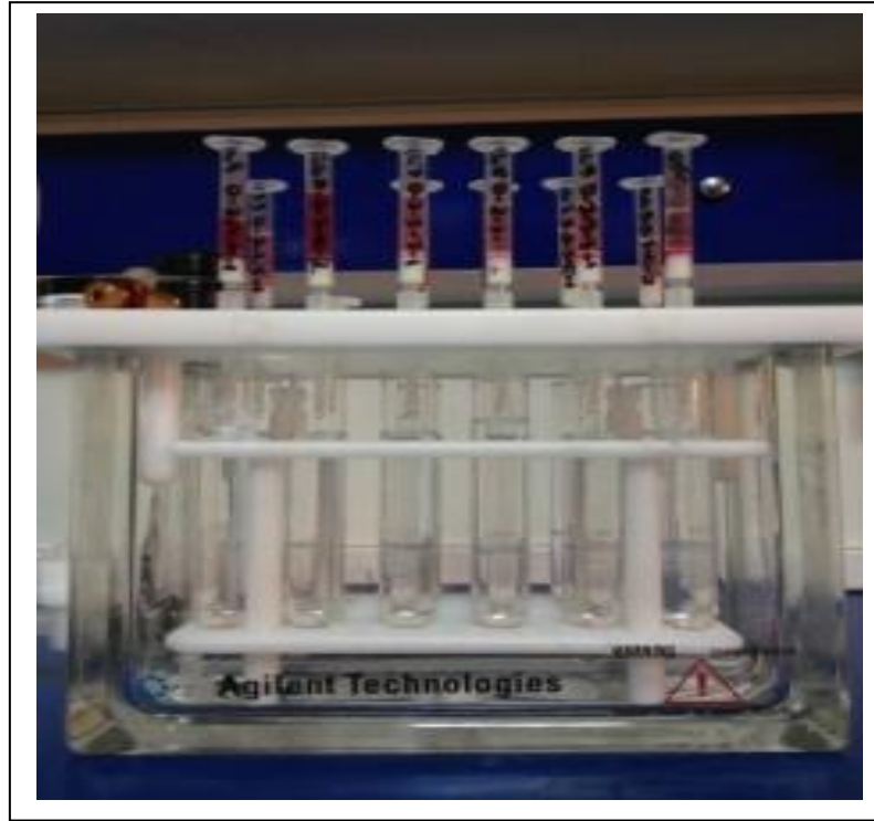
Şekil 3.26 Fenolik bileşiklerin HPLC okumaları için ekstraksiyonunda kullanılan vakum manifoldu
