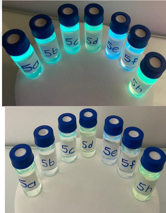
Şekil 3.4 Floresans özellikteki piridokumarin türevi halkalaşma ürünlerinin 254 nm’de ve gün ışığında \text{CHCl}_3 içerisinde alınan dijital fotoğrafları
