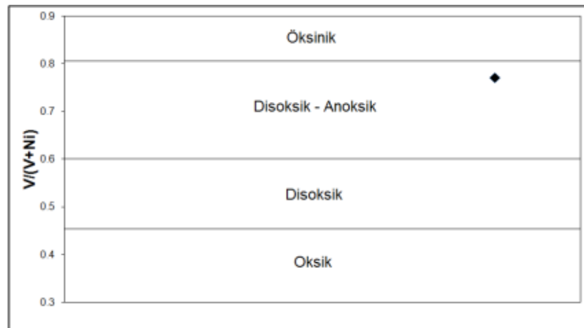
řekil 4.26 İncelenen SF-43 petrol rneęini paleoredoks iřaretilerine gre deęerlendirmesini gsteren grafik (Kholodov ve Nedumov 1991, Hatch ve Leventhal 1992, Jones ve Manning 1994, Wignall 1994, Kimura ve Watanabe 2001)
