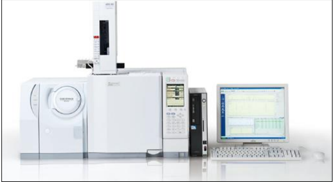
Şekil 3.2 Shimadzu GCMS QP2010-Plus gaz kromatografi kütle spektrometresi
