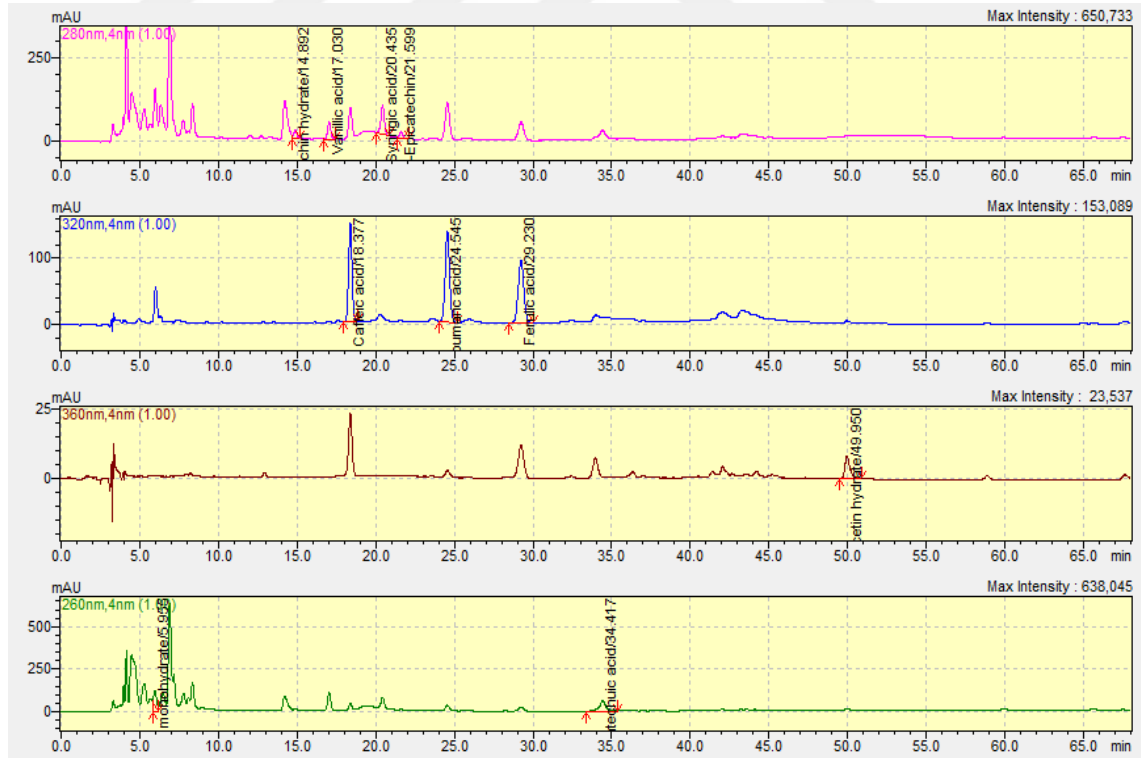
Şekil 4.13 %100 malt birasının Kieselguhr filtre girişinde 260, 280, 320 ve 360 nm'deki HPLC kromatogramları
