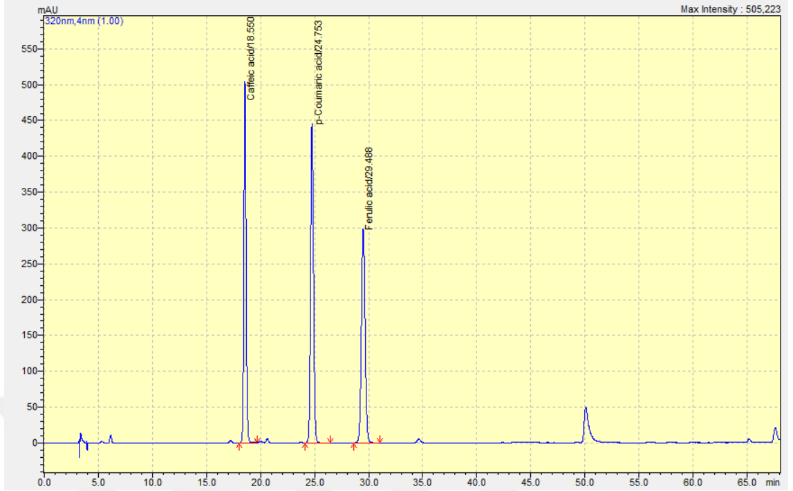
Şekil 4.6 Fenolik Standartların 320 nm dalga boyundaki HPLC kromatogramı
