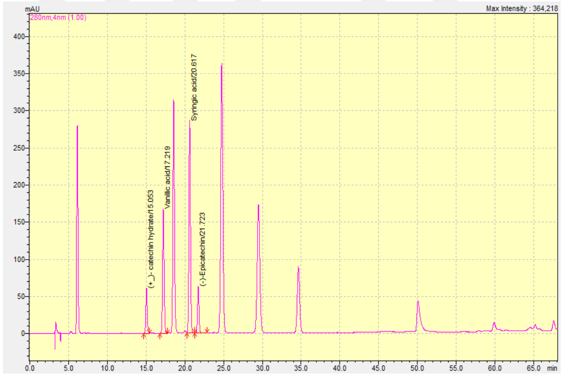
Şekil 4.5 Fenolik Standartların 280 nm dalga boyundaki HPLC kromatogramı
