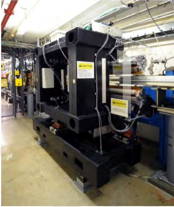
Şekil 2.15 APS bünyesinde kullanılan Revolver tipi undulator (solda) ve model görünümü (sağda)
