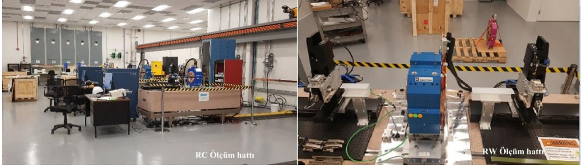
Şekil 4.45 APS-U Projesi kapsamında kurulan Magnet Ölçüm Laboratuvarı ölçüm hatları (Solda dönen bobin ve sağda dönen tel ölçüm hatları gösterilmektedir)
