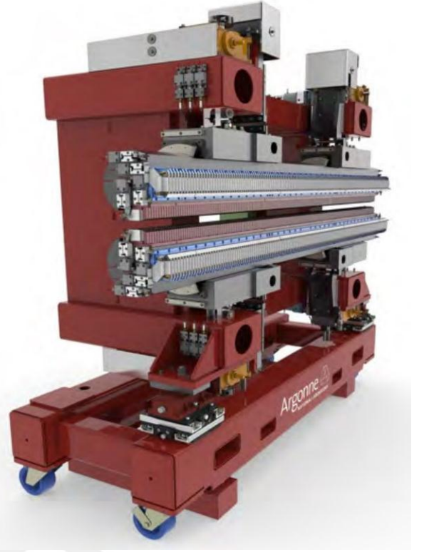
Şekil 2.15 APS bünyesinde kullanılan Revolver tipi undulator (solda) ve model görünümü (sağda)
