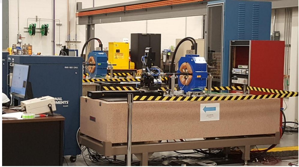
Şekil 4.48 ANL bünyesinde, APS-U projesi kapsamında ilk kurulan döner bobin ölçüm hattı (RC1)
