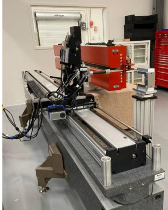
Şekil 2.6 APS-U bünyesinde test sürecindeki tipik bir eğici magnetin görünümü
