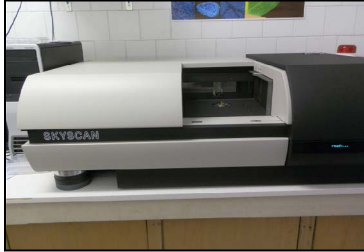
Şekil 2.10. Çalışmamızda kullanılan Mikro-BT cihazı.
