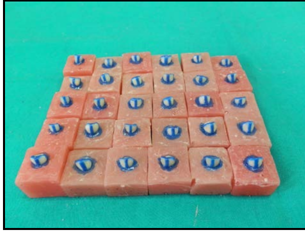
Şekil 2.3. Örneklerin başlangıç mine lezyonu oluşturulması için hazırlanması.
