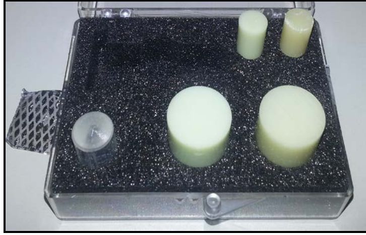
Şekil 2.9. Mineral yoğunluk kalibrasyonunda kullanılan fantom tipleri.
