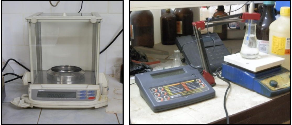
Şekil 2.4. Asit jel yapımında kullanılan hassas terazi ve manyetik çalkalayıcı.
