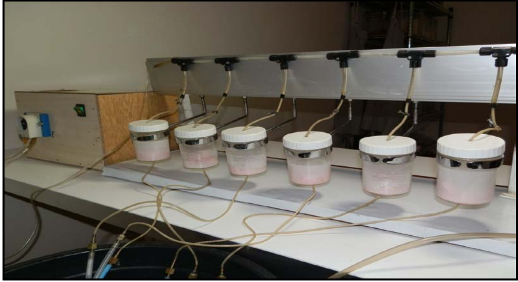
Şekil 2.6. Ağız içi ortamı taklit eden düzenek.
