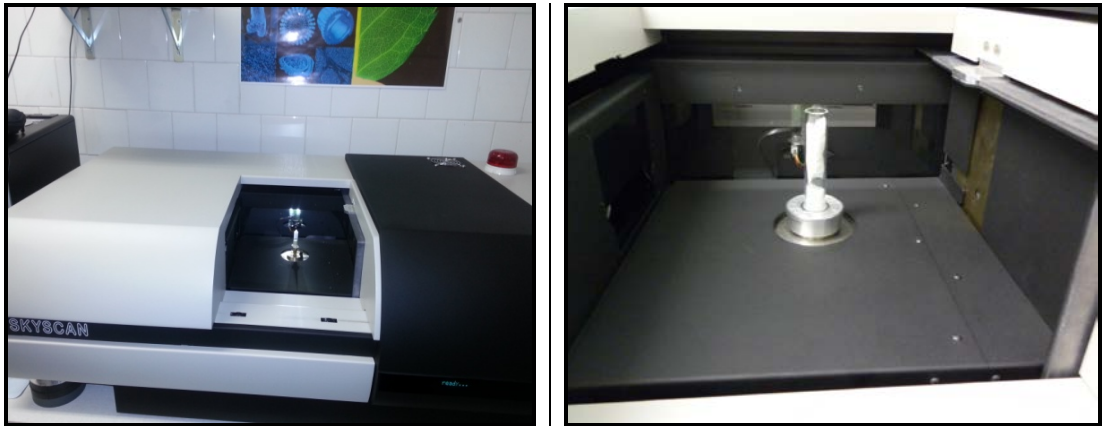
Şekil 2.11. Diş örneklerinin Mikro-BT taraması için 50cc'lik özel tüpe yerleştirilmeleri.
