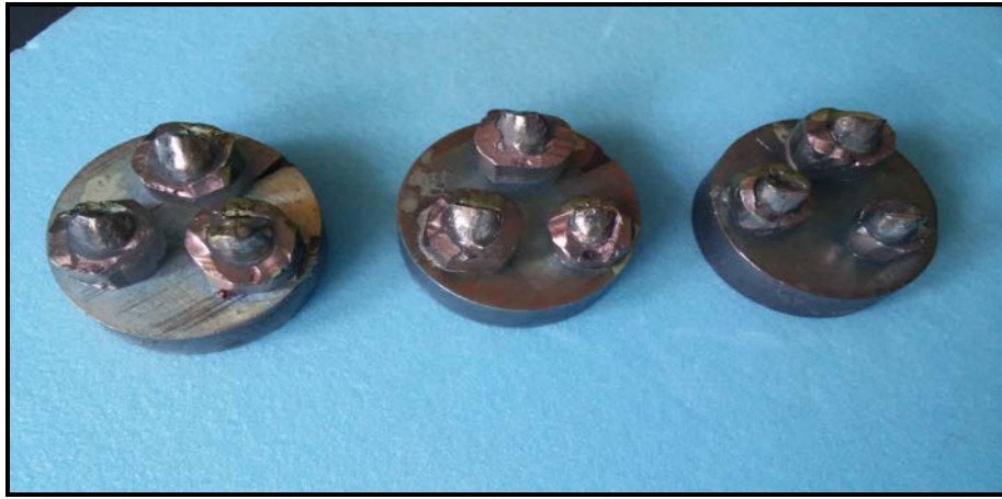
Şekil 2.17. SEM değerlendirmesi için altınla kaplanan örnekler.
