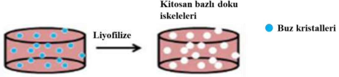
Şekil 2.12. Dondurarak kurutma yönteminin şematik gösterimi ( (64) no'lu referans değiştirilerek kullanılmıştır).
