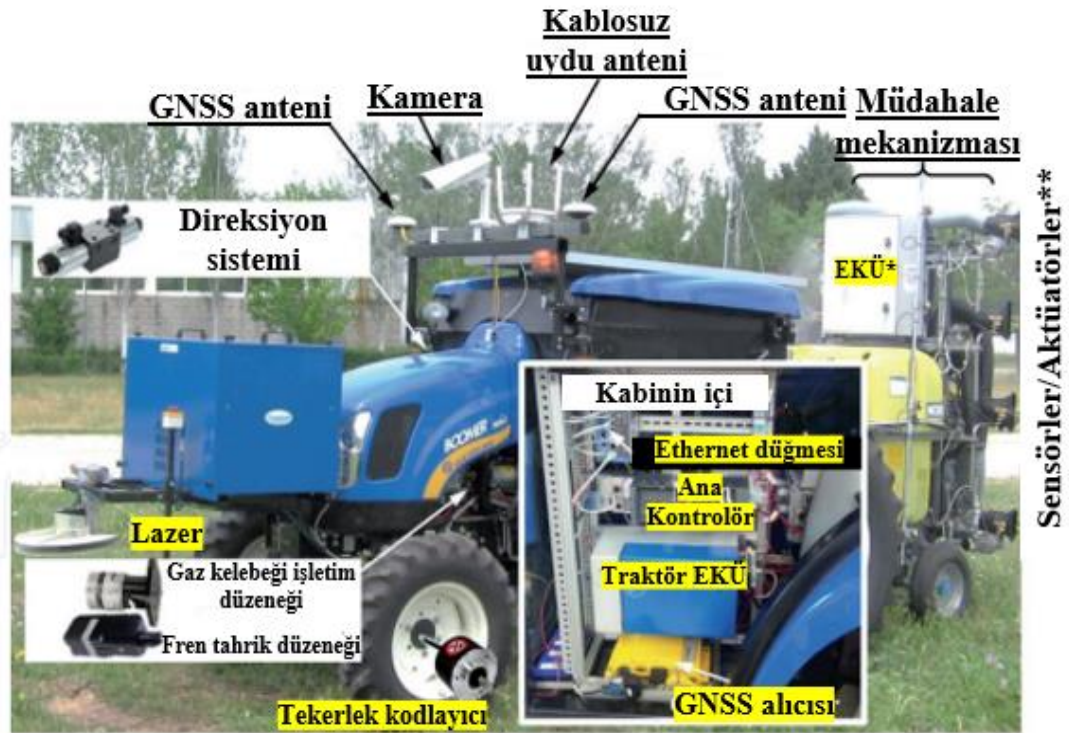
Şekil 5.7 Bir traktörü İKA'ya dönüştürmede sensör ve çalıştırma sistemlerinin dağılımı (Santos vd. 2020)
