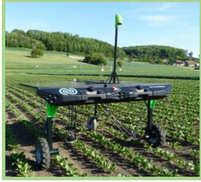
Şekil 5.9 Yabancı otla mücadelede kullanılan otonom bir mobil robot (Gaines 2018)
