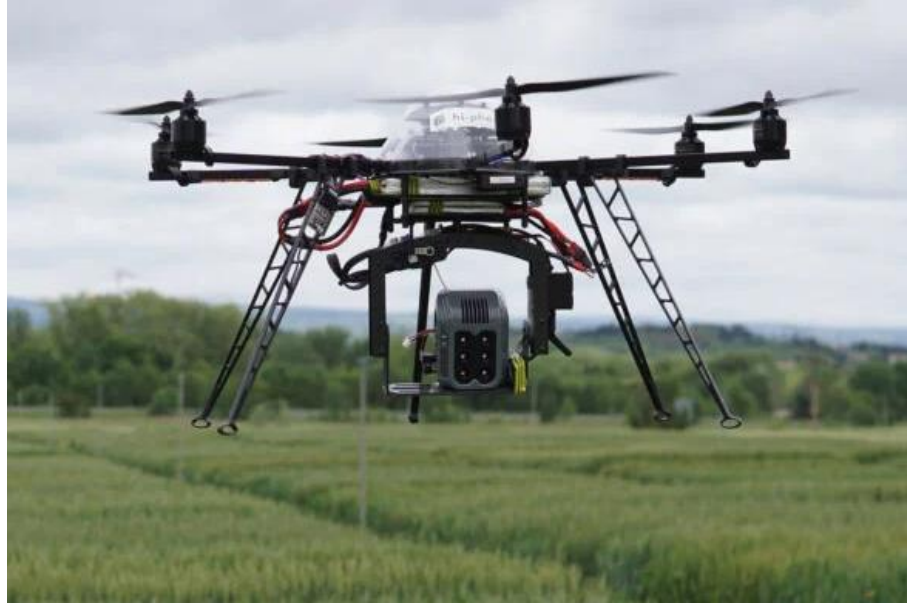
Şekil 5.19 Multi spektral kamera sensörlü bir tarım dronu (Happich 2016)
