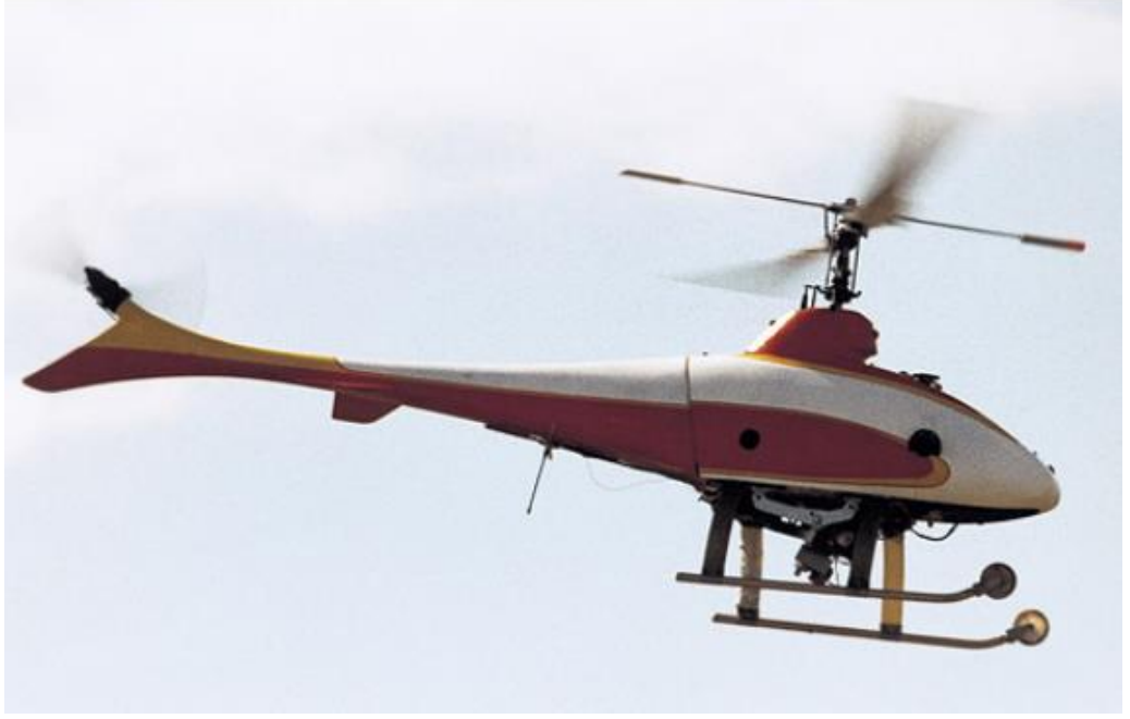
Şekil 5.12 Tarımsal amaçlı geliştirilen R-50 modelin ilk prototipi (Anonymous 2023g)
