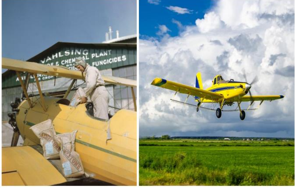
Şekil 5.13 Tarımsal amaçlı kullanım için modifiye edilen uçağa pilot kireçtaşı doldururken (Boeing-Stearman-Sol); günümüzde pestisit ya da gübre püskürtme amaçlı tarımda kullanılan bir uçak (Air tractor-Sağ) (Joiner 2012)
