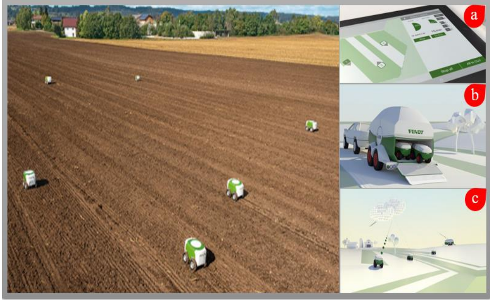
Şekil 5.10 Tohum ekimi yapan XAVER adlı otonom sürü robotlar (Anonymous 2023c).
