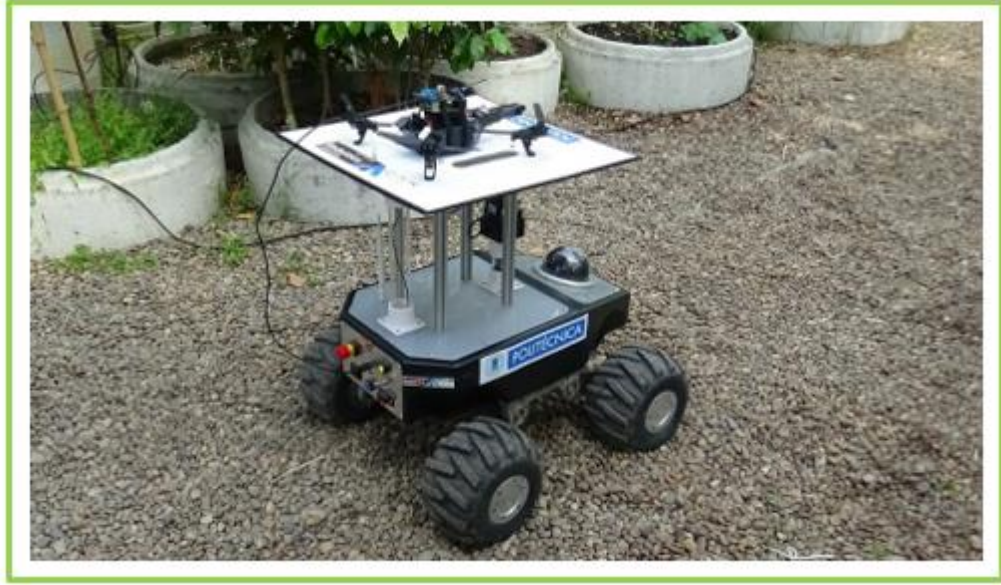
Şekil 5.11 İHA ve İKA’dan oluşan heterojen bir multi-robot sistemi (Roldán vd. 2016)
