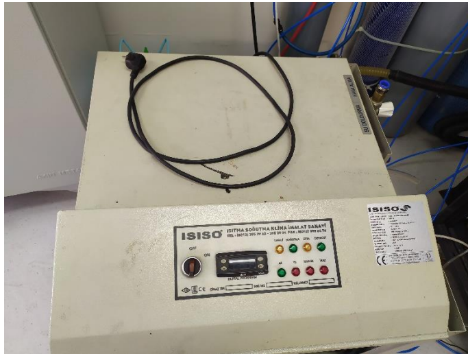
Şekil 3.21 Kaplama yapılırken kullanılan soğutma cihazı
