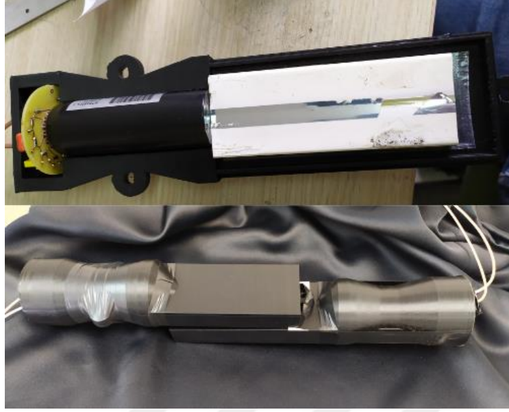
Şekil 4.3 Bir sintilatör ve fotoçoklayıcı tüpten oluşan tetikleme sayacı
