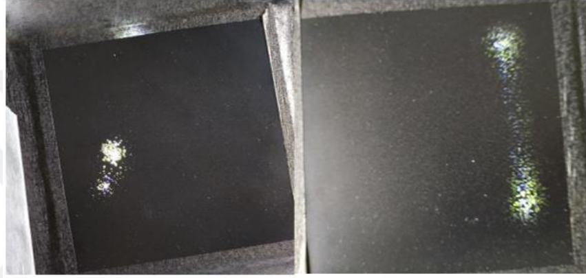
Şekil 3.7 Amsterdam markalı cam numunelerde oluşan delikler
