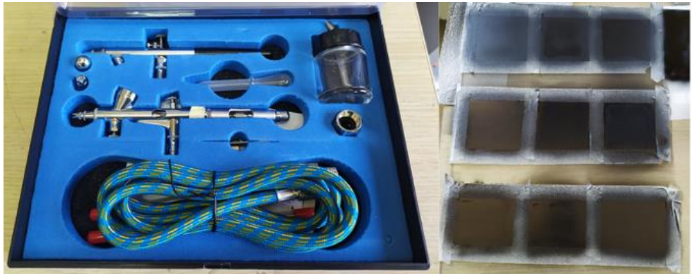
Şekil 3.2 Cam elektrot üretmek için kullanılan hava tabancası ve camlara uygulanan aday boyalar
