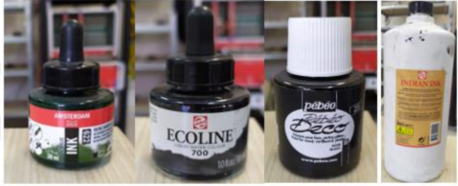
Şekil 3.1 Elektrot yapımında kullanılan aday boyalar
