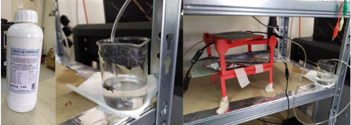
Şekil 4.1 RPC gaz sızdırmazlık testi sistemi fotoğrafları. a) Yüksek yoğunluklu silikon yağı, b) baloncuk sistemi ve c) test istasyonu fotoğrafları
