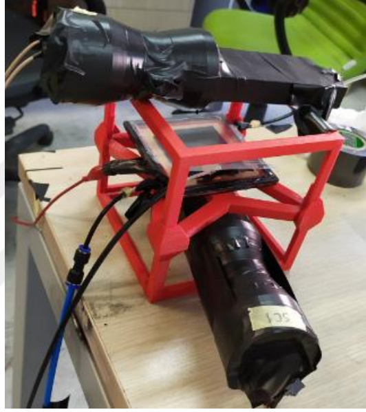
Şekil 4.6 Kozmik müon test istasyon kurulumu
