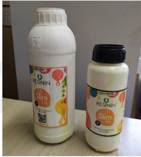
Şekil 3.30 RPC elektrotlarının birleştirilmesini ve gaz sızdırmazlığını sağlamak için kullanılan çift bileşenli epoksi
