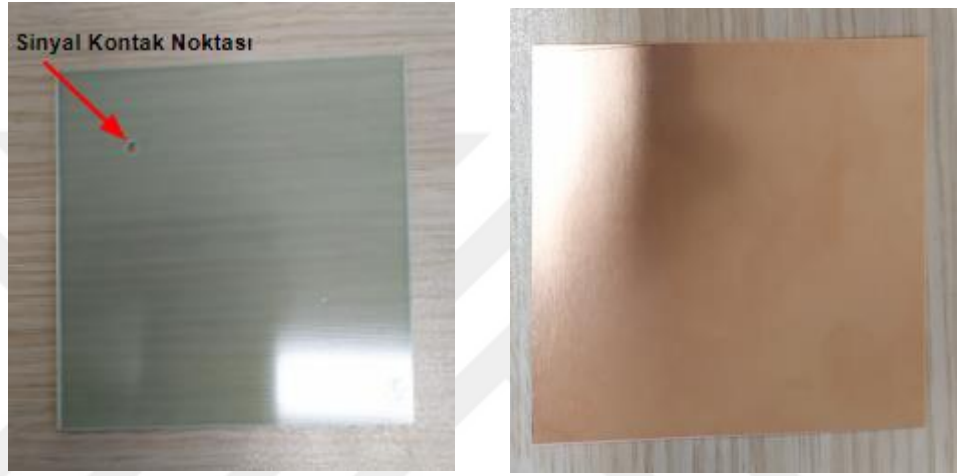
Şekil 3.16 Tek kanallı sinyal okuma kartında kullanılan malzemeler
