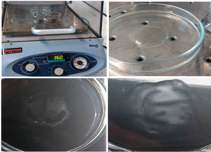
Şekil 2.4. Dağılma süresi testinde filmlerin cam petrilere görüntüsü.
