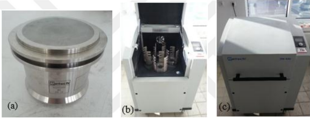
Şekil 3.2.a. Sırasıyla tungsten-karbid jar, b.c. ball-milling cihazı
