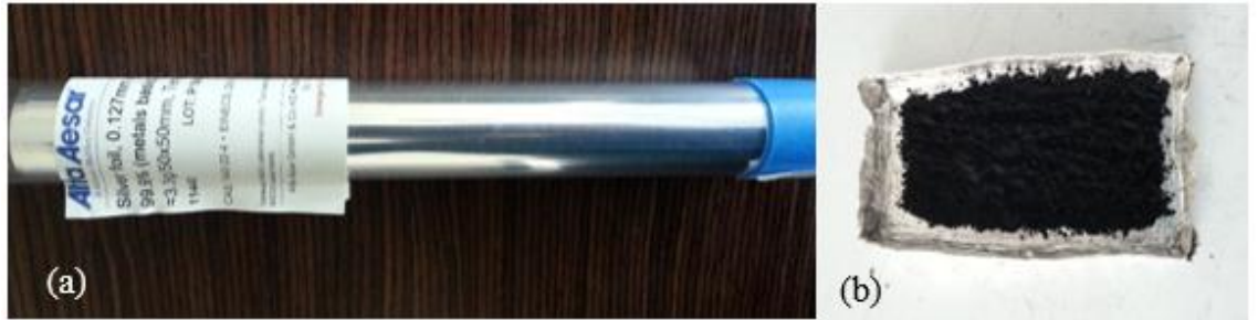
Şekil 3.3.a. Gümüş plaka, b. gümüş plakadan yapılmış pota içerisinde BSCCO toz
