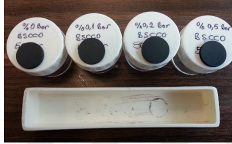
Şekil 3.7 Kalsinasyon ve katkılama işlemlerinin ardından preslenerek yığın hale getirilen BSCCO yığın numuneler
