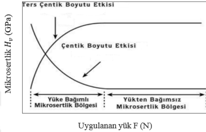
Şekil 4.26 ÇBE ve TÇBE şematik gösterimi
