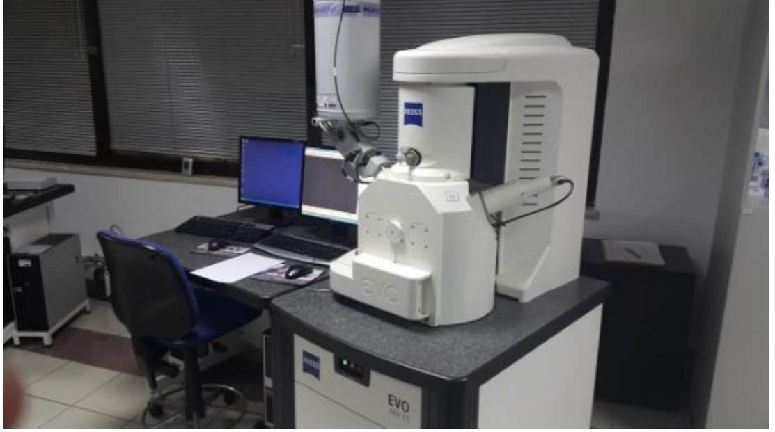
Şekil 2.16. Elektron mikroskobu (SEM) Zeiss Evo Ma 15 modeli (Jandarma Kriminal Daire Başkanlığı Lab.)
