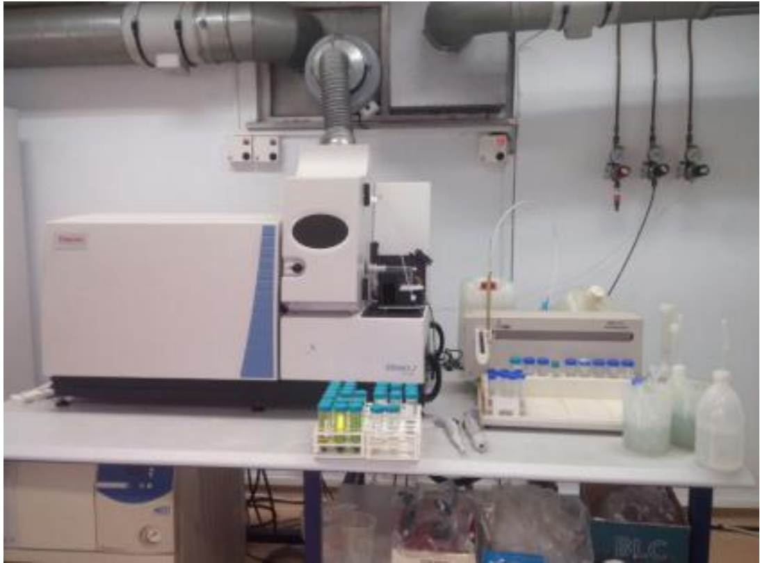
Şekil 2.14. ICP - MS cihazı ve analize hazır çözeltiler
