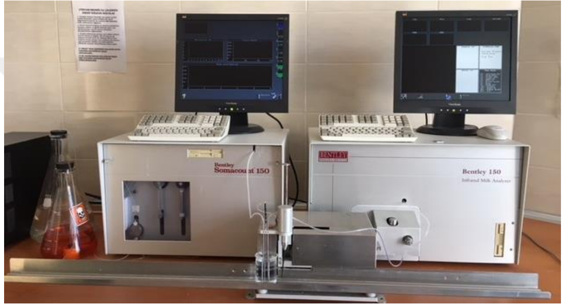
Şekil Ek-3.9. Combi 150 entegre süt analiz cihazı
