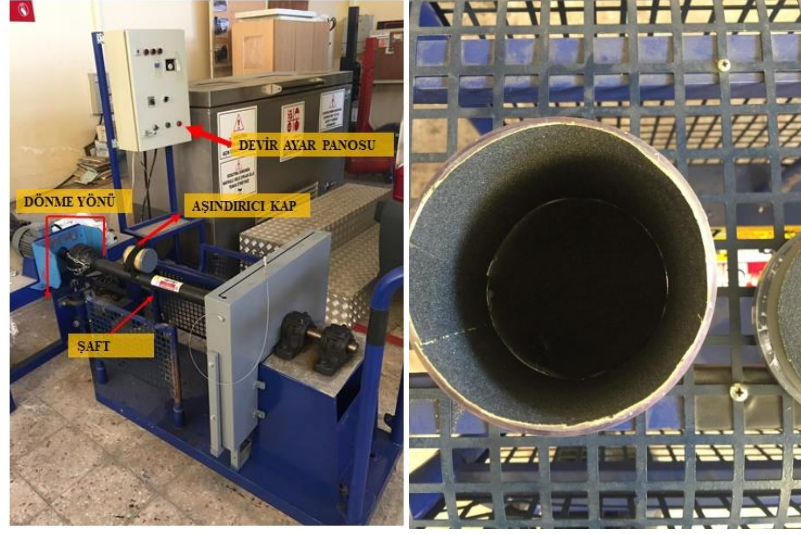
Şekil 3.1 Mekanik aşındırma sistemi ve aşındırıcı kabın görünümü
