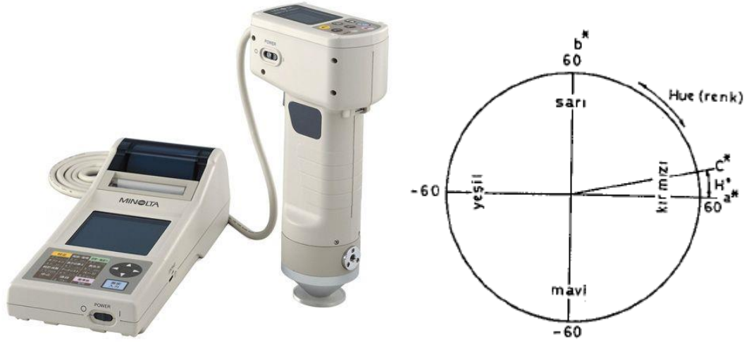
Şekil 3.6 Renk ölçüm cihazı ve CIE L*,a*,b*,C* ve H sistemleri (Üren 1999)
