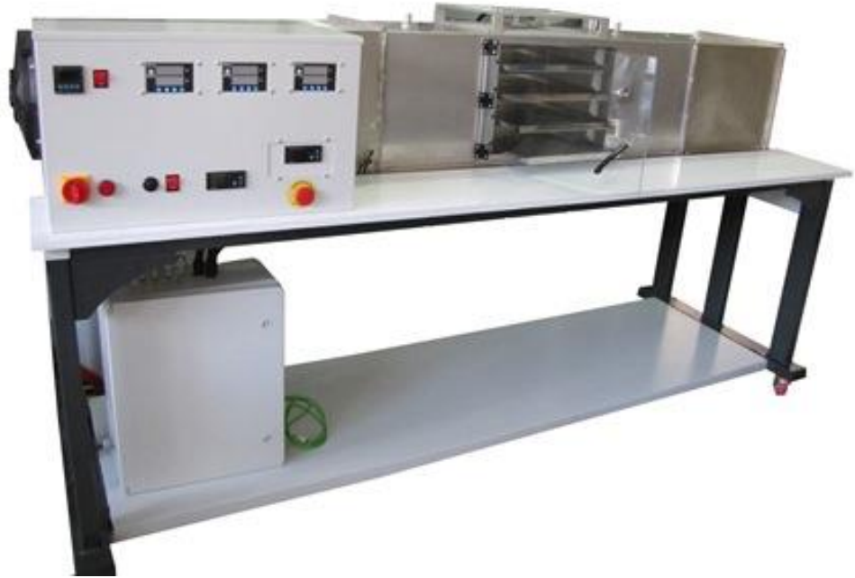
Şekil 2.5 Tepsili kurutucu cihazı ( http://www.cokesen.com , 2013)
