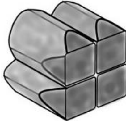
Şekil 3. 2 Yonca HPGe (Clover) dedektörünün şematik gösterimi (Siciliano vd. 2013)
