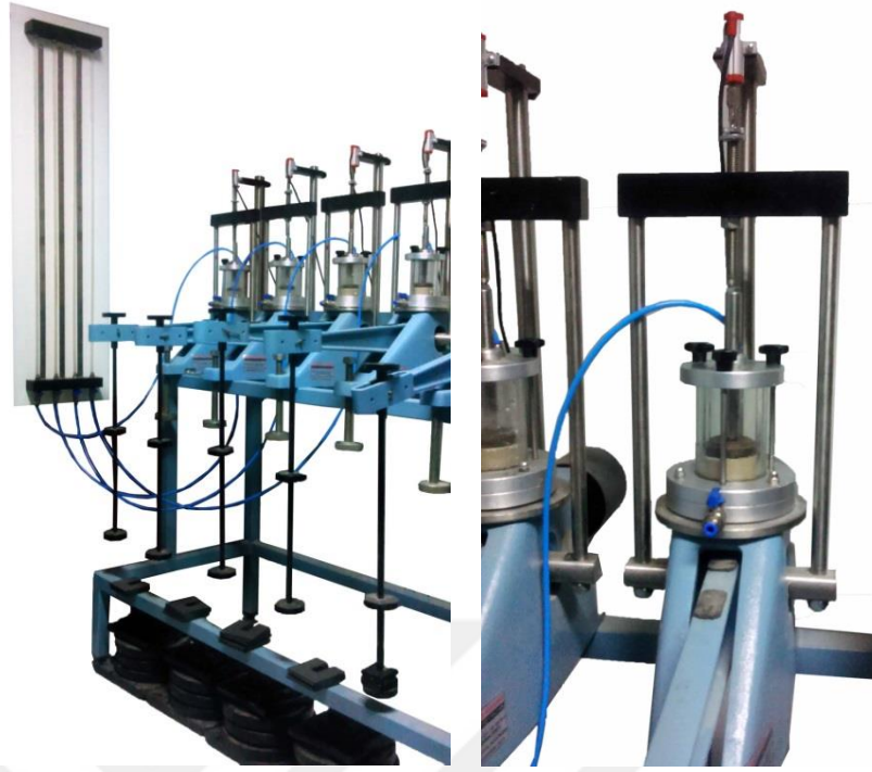
Şekil 4.24 Kombine düzeneğin konvansiyonel ödometre yükleme ünitesine yerleştirilmesi
