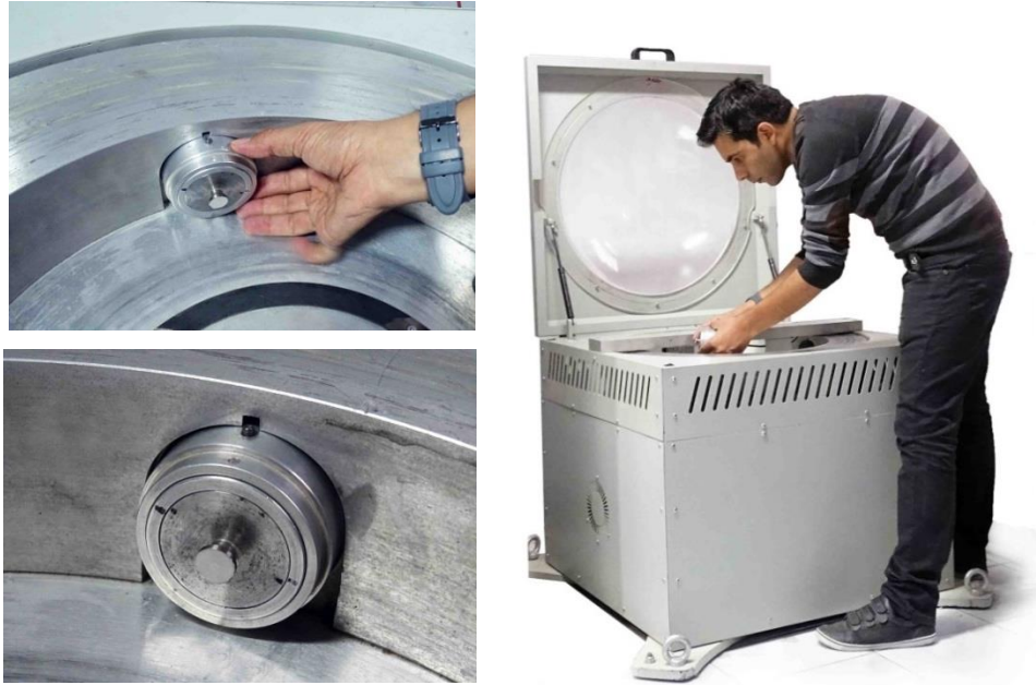
Şekil 4.28 Hücrelerin santrifüj-konsolidasyon düzeneğine yerleştirilmesi
