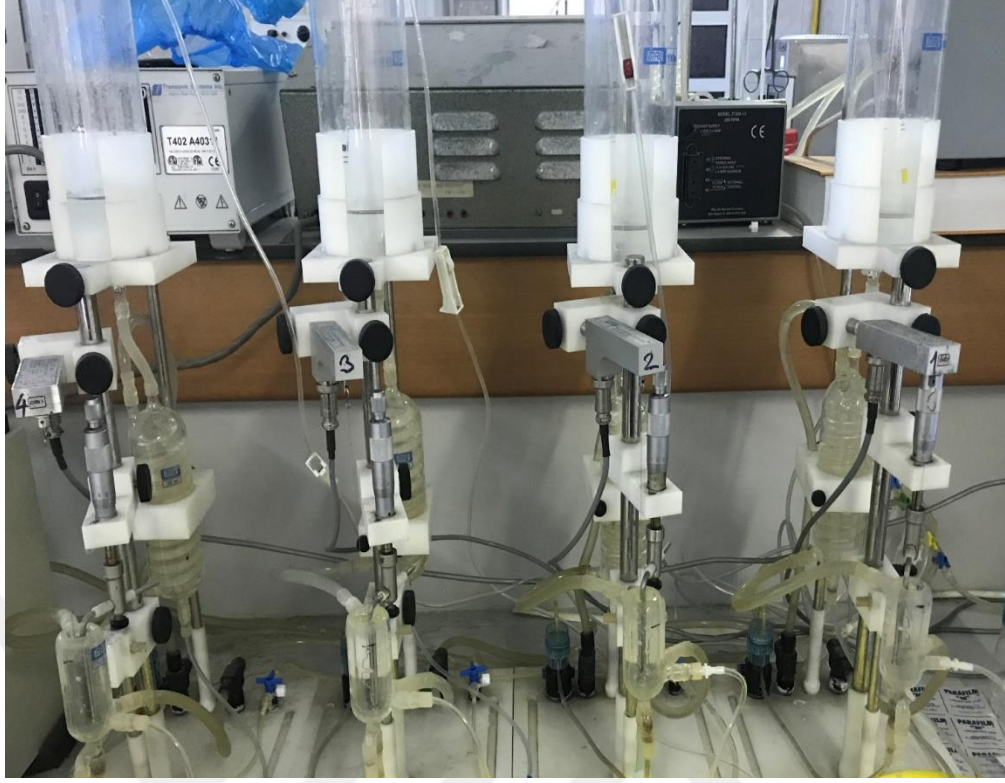
Şekil 2.4. Torasik Aortanın Organ Banyosuna Asılması
