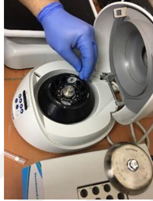
Şekil 2.2 24 saat inkübasyondan sonra çöken eksozomların toplanması için santrifüj edilmesi
