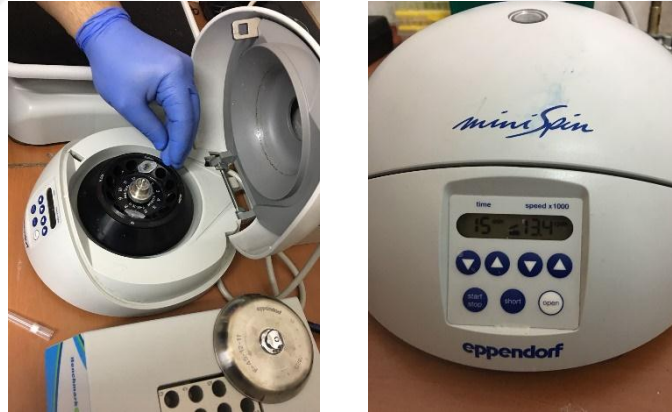
Şekil 2.4 1 gece inkübasyondan sonra çöken eksozomların toplanması için santrifüj edilmesi
