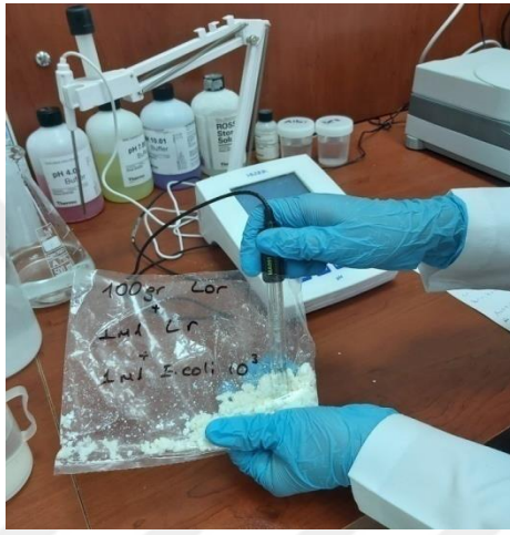
Şekil 2.10. Lor peynirlerinde pH metre ile analizin yapılması.
