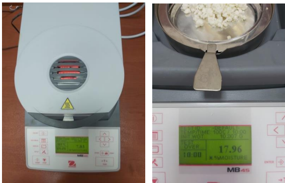
Şekil 2.11. Lor peynirinde kuru madde cihazı ile kuru madde analizinin yapılması.
