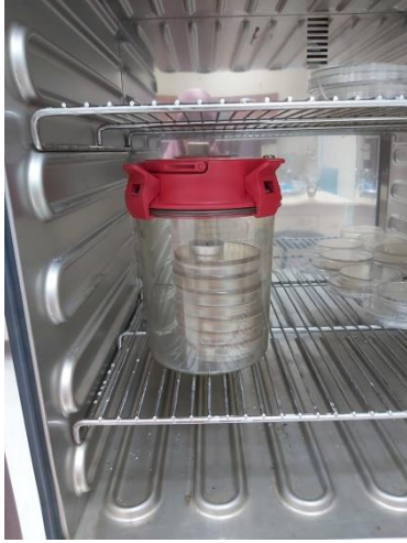
Şekil 2.6. Anaerobik jar ile sağlanan anaerobik ortam.
